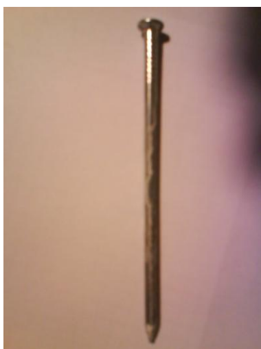
Att. 3.9. un 3.10. Naglas ar korozijas produktiem.
